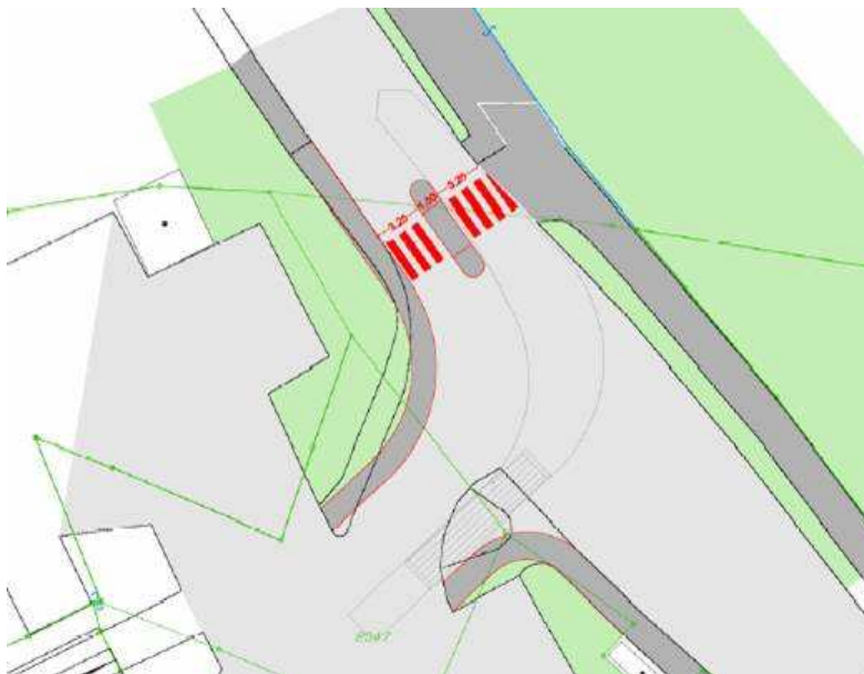
Abbildung 38: Mittelschutzinsel zur Erhöhung der Verkehrssicherheit beim Bahnhof in Klaus
