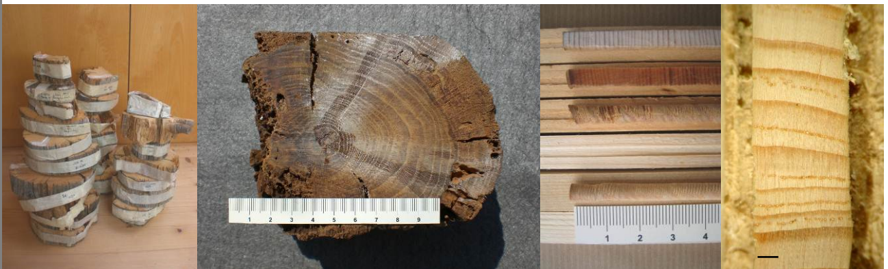
Kappstücke – Hölzer von Bargenruinen; präpariertes Kappstück; Probenmontage und Lupenbild eines auf einem Träger fixierten Bohrkerns 10 (Fichte); Maßbalken \cong 1 mm
