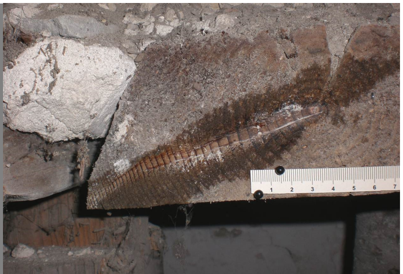
Bildausschnitt eines präparierten, mit Wasser benetzten und Kreidestaub kontrastierten Proberadius an der gesägten Querschnittsfläche einer Deckenbohle
